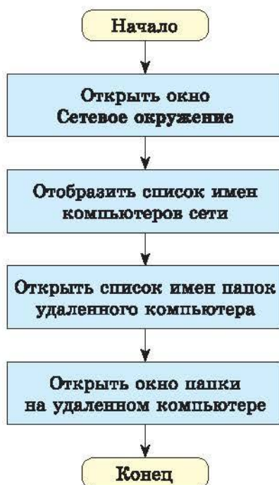
Рис. 5.8. Блок-схема алгоритма навигации в локальной сети
